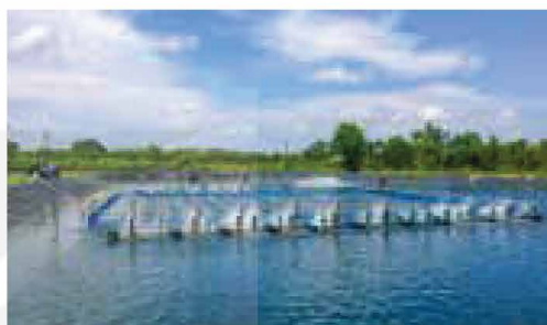
Hình 20.4. Quạt nước tăng lượng khí oxygen cho ao nuôi
