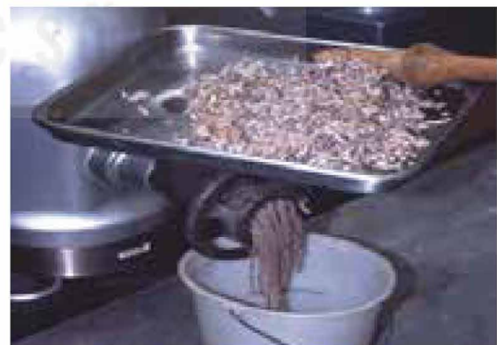
b) Xay cá tạp làm thức ăn cho động vật thủy sản
